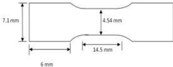
**Fig. 1 Tensile Test Specimen**
