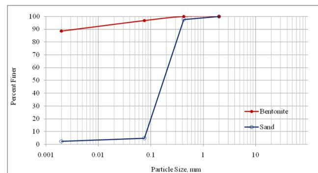
**FIGURE III GRAIN SIZE DISTRIBUTION CURVES**
