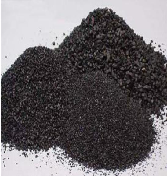
**Fig 1 Copper slag**
